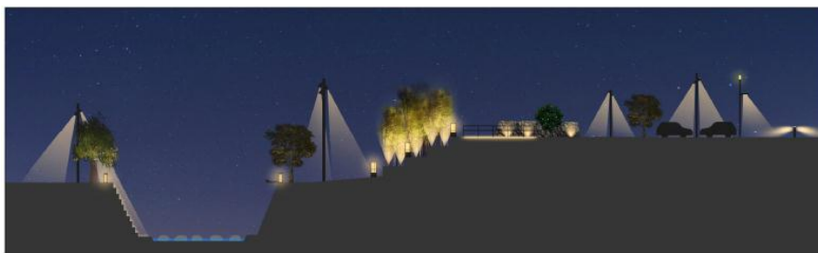
樹木ライトアップ、河川付近を照射している照明は消灯。（但し、竹林は点灯） その他の鏡光タイプの照明は、約50%で点灯。
