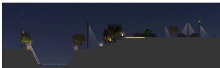
深夜は、鏡光タイプの照明で約10%点灯。安心安全に通行できる必要最低限の明るさを確保。
