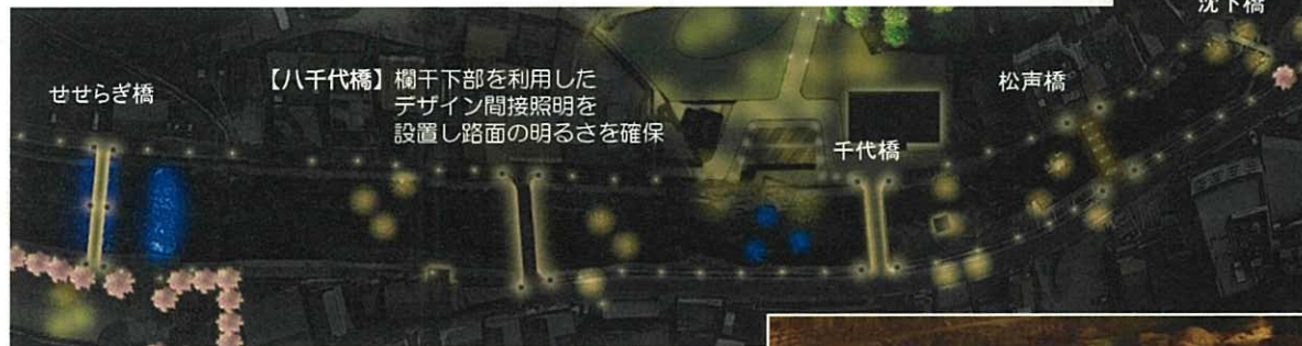
【せせらぎ橋】木造の吊柱をカラーライトアップ、地覆部・路面への間接照明
