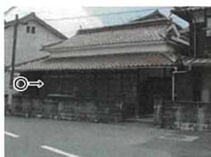
○1階開口部に木製格子を設置し防犯性を高める
