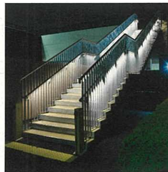
手すり照明のみで通路階段を照射した事例
