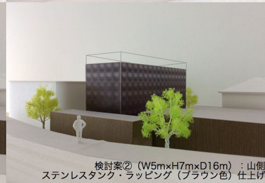
検討案② (W5m×H7m×D16m)：川側・下流より ステンレスタंक・ラッピング (ブラウン色) 仕上げ
