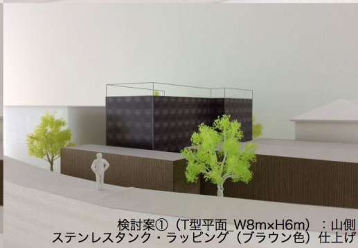
検討案① (T型平面 W8m×H6m)：川側・下流より ステンレスタंक・ラッピング (ブラウン色) 仕上げ
