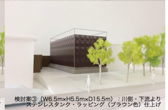
検討案③ (W6.5m×H5.5m×D15.5m)：川側・上流より ステンレスタंक・ラッピング (ブラウン色) 仕上げ
