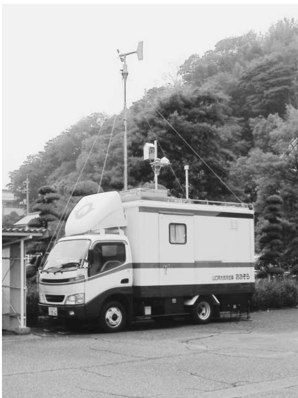
計測中の大気汚染測定車
