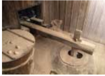
水車を使って土を砕くサコンタは良質の粘土を作る。三ノ瀬の萩焼はこのように土づくりから始まる。
